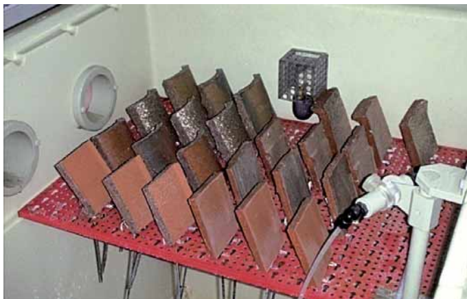
2. Posizione di una serie di provini nell'apparecchiatura per il test in nebbia salina.
