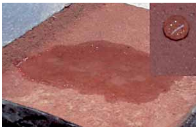
4. Prova di assorbimento su tegola di cemento (tipo 6A): a sinistra sul campione invecchiato, a destra, in alto (riquadro), su quello non invecchiato.
