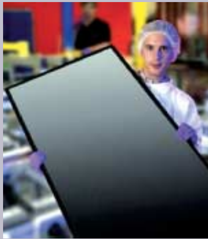
Fig. 3 - Sistema a base di diselenurio di indio rame gallio.
