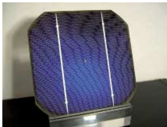
Fig.1 - Celle con silicio monocristallino.
